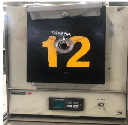
Figura 3.4 Mufla de resistencia utilizada para el proceso de sinterización.
