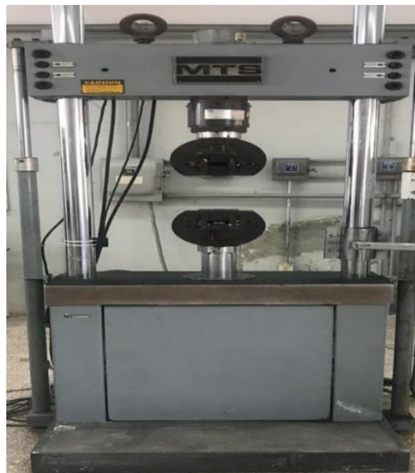
Figura 3.8. Máquina de compresión (marca MTS, modelo 661.23B).
