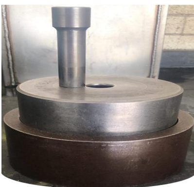
Figura 3.3. Matriz cilíndrica empleada para obtener las piezas compactadas en la máquina de tensión.
