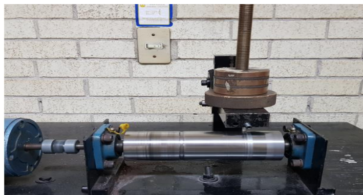
Figura 3.7. Sistema utilizado en el ensayo de desgaste tipo disk-pin-drum.
