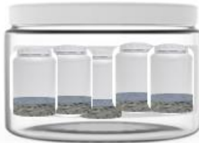
Figura 4.9. Esquema del equipo para el mezclado de los polvos de aluminio con los respectivos refuerzos cerámicos.
