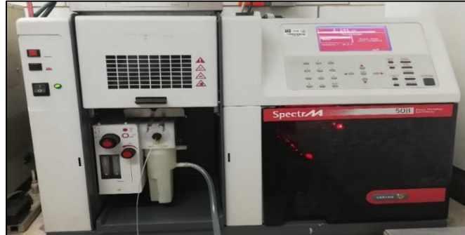
Figura 13. Espectrofotómetro de Absorción Atómica utilizado en la experimentación.
