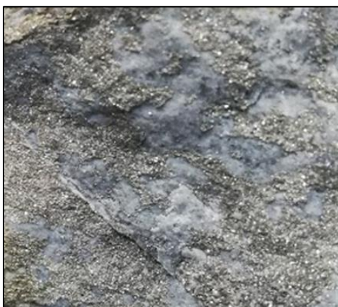
Figura 2. Muestra de mineral observada a través de un microscopio estereográfico a 50X.
