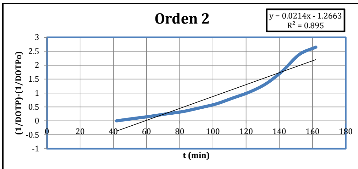
Figura A33. Orden 2 en la reacción de hidrogenación del DOTP.
