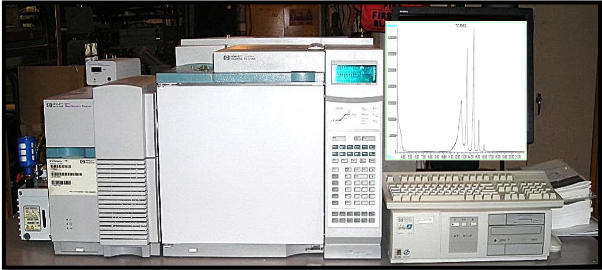
Figura A. Equipo empleado para el análisis en cromatografía de gases.
