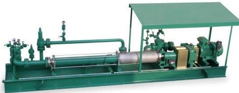
Ilustración 36. Bomba multifásica convencional marca NEMO.
