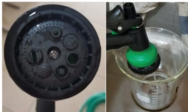
Imagen-A6. 10 a) Fotografía de las salidas de rociador, b) Fotografía de la toma de tiempo para llenar 1 L de agua
