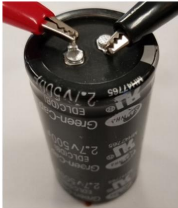
Imagen 69 Súper capacitor que utilizará en la tercera prueba
