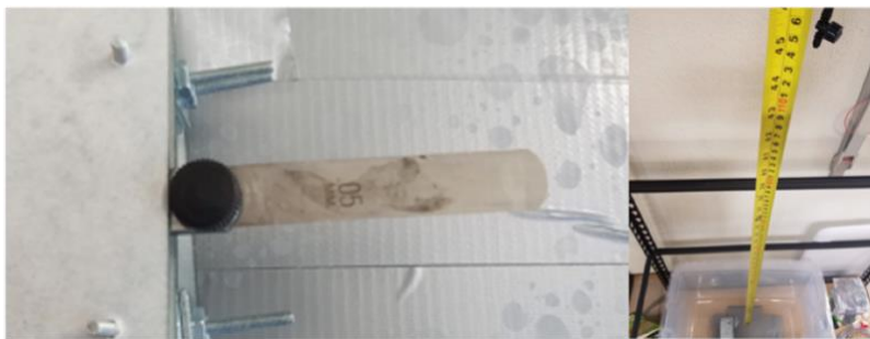
Imagen-A4. 7 a) Foto de la lámina de 0.05 mm expuesta sobre el soporte, b) Medición de la distancia entre el gotero y la lámina a ser golpeada.
