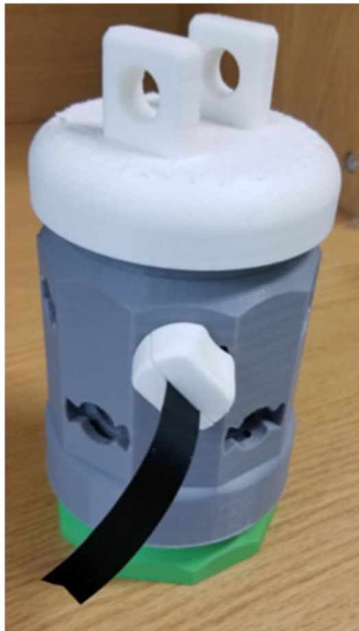
Imagen 50 Imagen del ensamble del conjunto de tapas de presión aprisionando el sensor laminar, ya adentro de la torre base y a medio giro de quedar en su posición final.
