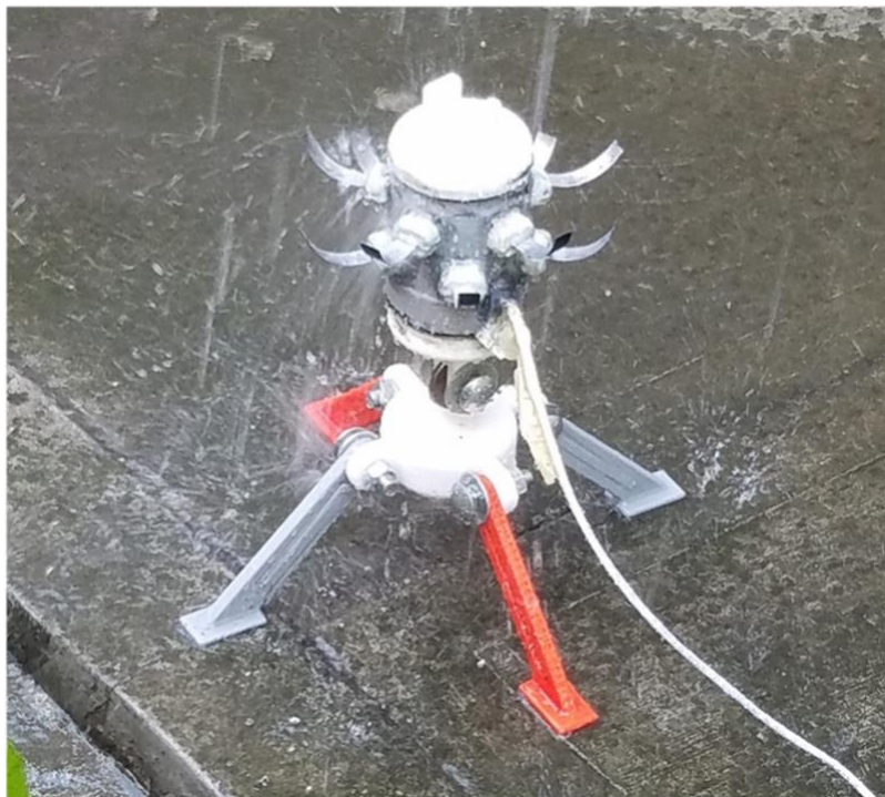
Imagen 70 fotografía del instante en que las gotas de lluvia golpean al dispositivo en la tercera prueba
