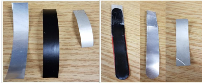
Imagen-A5- 16 a) Fotografía de los elementos que contiene el sensor laminar, en la izquierda esta la lámina de aluminio, en el centro esta la cinta de aislar y en la derecha esta el film piezoeléctrico, b) Fotografía del proceso de recuperación del film piezoeléctrico de sensor deteriorado.
