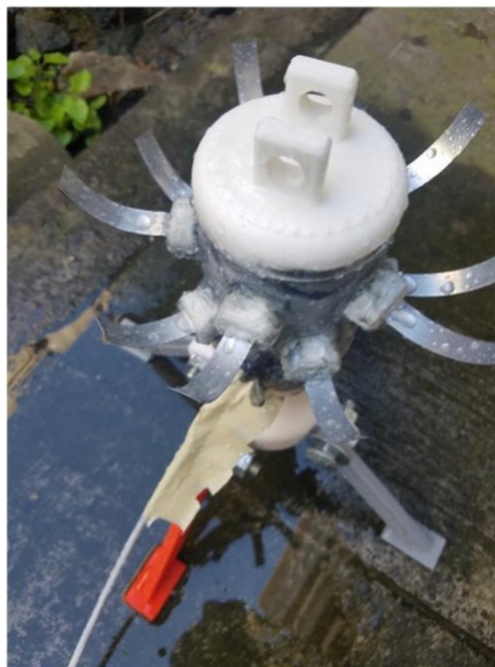
Imagen 66 Fotografía del dispositivo cubierto con grasa de bujía después de haberle caído gotas de agua durante un minuto
