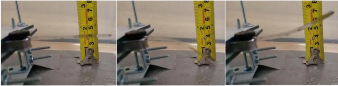
Imagen 22 Fotografías del momento de impacto de una gota de agua sobre una lámina en cantiléver a) Posición inicial (posición cero), b) Posición máxima inferior (posición máxima negativa), c) posición máxima superior
