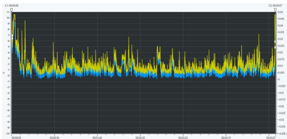
Imagen 67 Gráfica de la señal obtenida a la salida del diodo rectificador en CD, las líneas amarillas representan al voltaje y su escala de medición reportada son de -10 a 11 volts, las líneas azules representan la corriente eléctrica y su escala de medición va de los -4.02E-2 a los 0.05 amperes.
