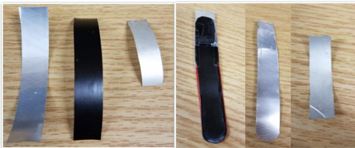
Imagen 48 a) Fotografía de los elementos que contiene el sensor laminar, en la izquierda esta la lámina de aluminio, en el centro esta la cinta de aislar y en la derecha esta el film piezoeléctrico, b) Fotografía del proceso de recuperación del film piezoeléctrico de sensor deteriorado.
