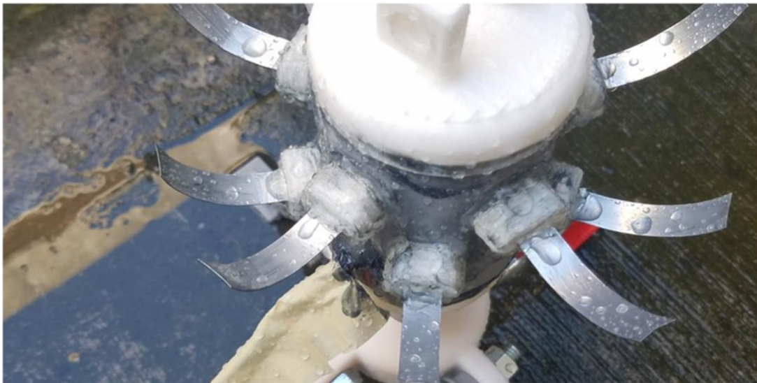
Imagen 64 Fotografía de la nueva impermeabilización del dispositivo, una capa de grasa para bujías impide el paso del agua a las ranuras que dejan los ensambles de los elementos.
