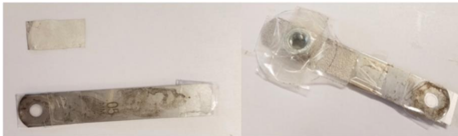
Imagen-A4. 10 Imagen de la lámina de metal y la pieza de film piezoeléctrico, b) Imagen del sensor laminar armado.
