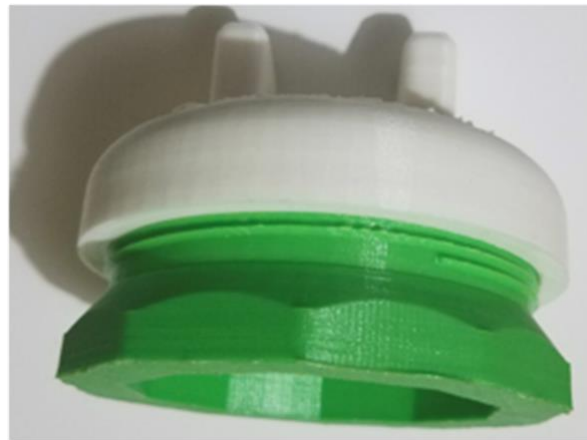
Imagen-A5. 12 Fotografía de la conexión de la tapa de cierre superior (pieza blanca) y una pieza de prueba con cuerda externa (pieza verde).
