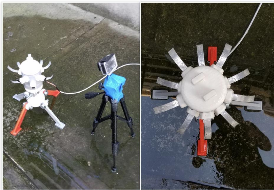
Imagen 62 Fotografía del momento en que las gotas de lluvia impactan a los sensores del dispositivo de generación
