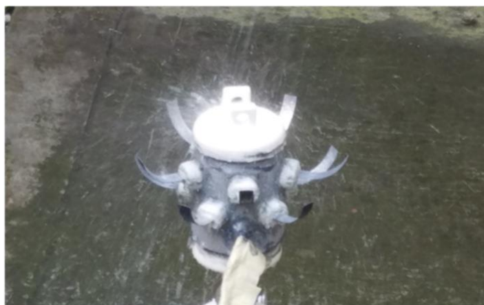
Imagen-A6. 16 Fotografía del instante en que las gotas de lluvia artificial impactan al dispositivo y a sus sensores
