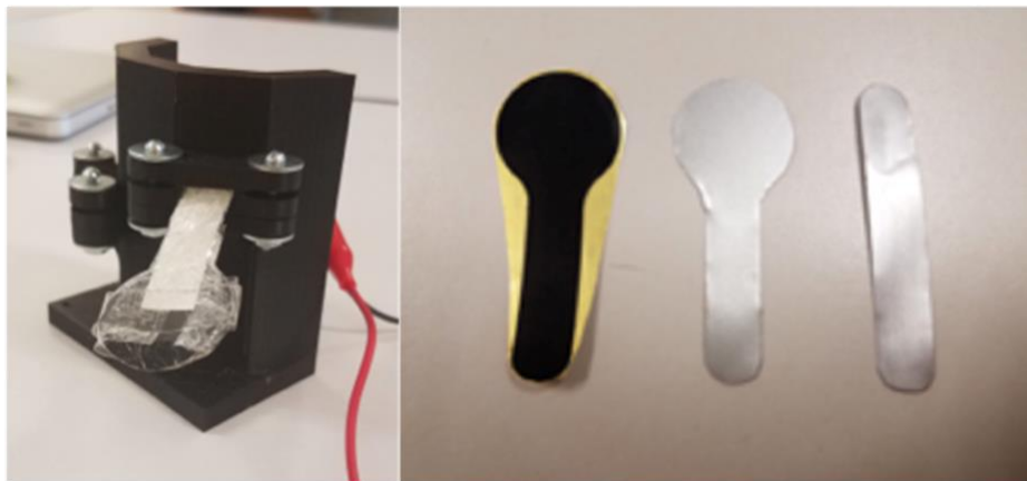
Imagen-A4. 20 a) Modelo experimental con dos salientes impreso en 3D, b) Fotografía las láminas de latón, la lámina de cuchara de la izquierda muestra al latón sin ser cubierto por pintura, las láminas de la derecha están cubiertas por pintura en aerosol.
