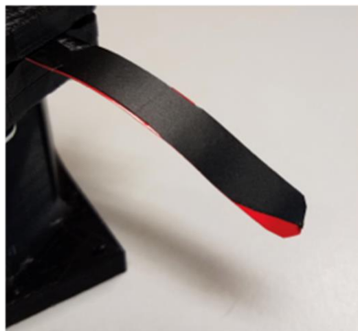
Imagen 28 Fotografía del sensor laminar con lámina de aluminio de una lata de refresco como soporte.
