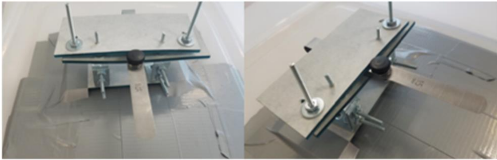
Imagen-A4. 6 Estructura de soporte del calibrador de láminas, con una lámina expuesta como viga en cantilever
