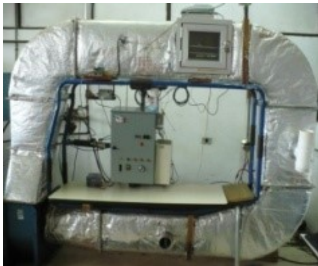
Figura 2.2: Secador de bandeja de bucle convectivo usado para el ajo.
