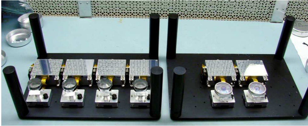
Figura 21: Cuatro cámaras de vuelo Navcams (izquierda) y dos cámaras de vuelo Hazcams (derecha). Las lentes de la cámara tienen una cubierta protectora que se quita antes del vuelo
