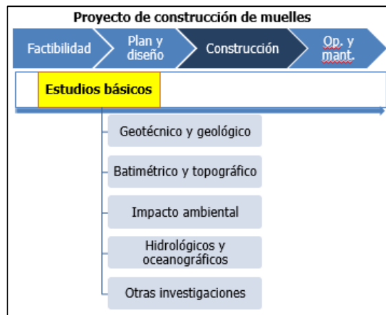
Figura 27. Los estudios de ingeniería dentro del proyecto de construcción de muelles
