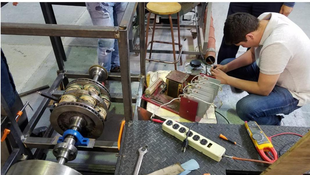
**Ilustración V.1.1 Conexión al suministro eléctrico de corriente alterna.**
