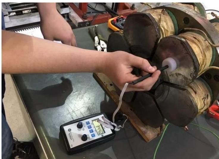
**Ilustración III.2.3** Medición de Flujo Magnético en la PAU
