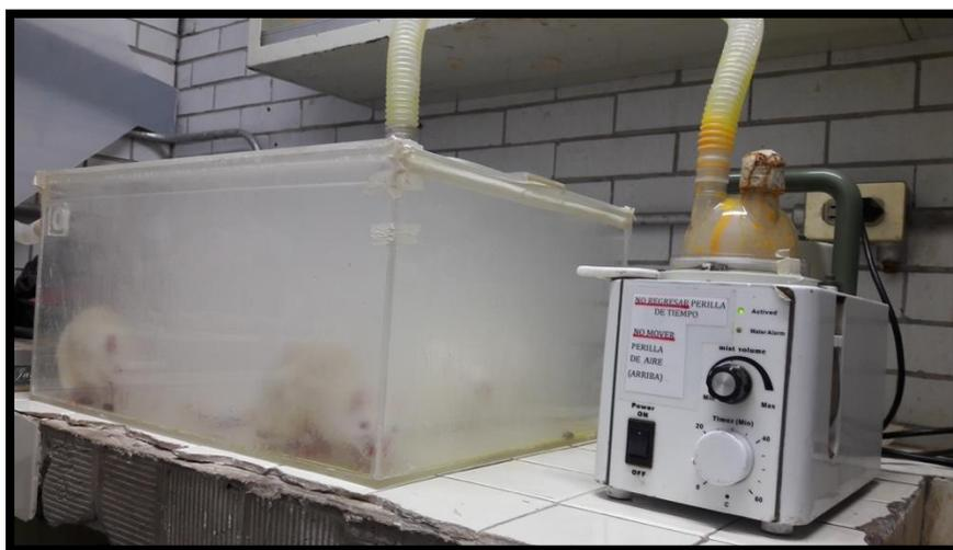
Figura 1. Inhalación. Se observa las ratas dentro de la caja de acrílico expuestas a  $V_2O_5$  proveniente del nebulizador.
