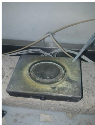
**Fig. 4-10** Mufla en forma cuadrada con placa térmica circular sobre la cual se coloca el sustrato justo antes de iniciar el depósito. Además, la mufla contiene en su superficie un baño de estaño.
