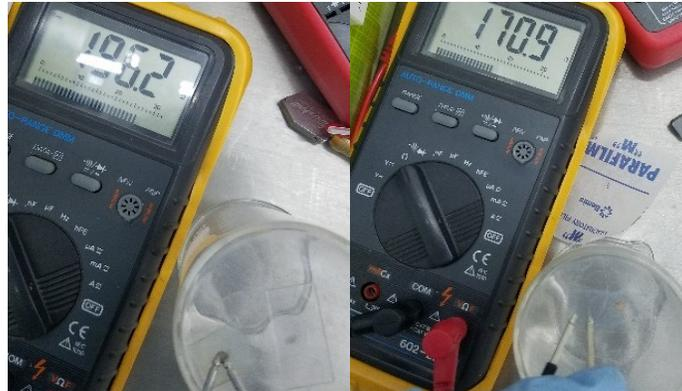
**Fig. 5-1** Fotografías donde se aprecia la medición de resistencias correspondientes a un par de películas depositadas sobre sustratos de  $\text{SiO}_2$ .
