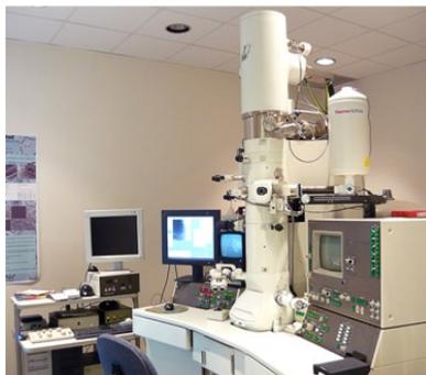
**Fig. 4-14** Microscopio electrónico de transmisión de alta resolución (HRTEM) de emisión de campo (JEOL, JEM 2010)
