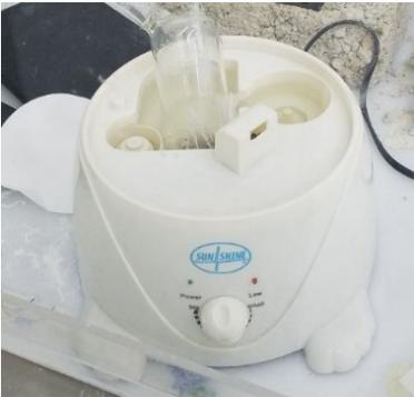
**Fig. 4-5** Atomizador ultrasónico (AU) casero SunShine modelo ELEHUM001E.
