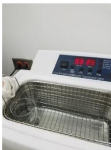
**Fig. 4-3** Baño Ultrasónico (Modelo 8892). Limpieza de los sustratos de SiO<sub>2</sub>, mediante un Baño Ultrasónico durante 5min.
