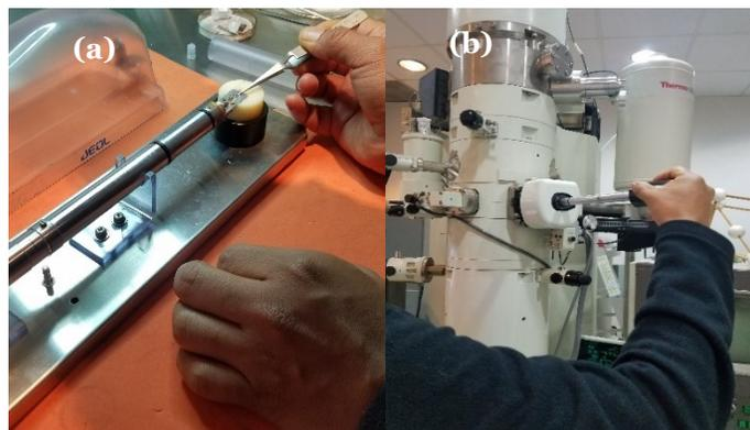
**Fig.- 4-16 a)** Se coloca en el portamuestras la rejilla con la muestra que se pretende observar en TEM, **b)** Introducción del portamuestras en el TEM.
