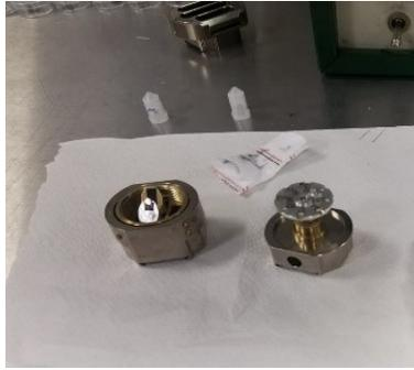
**Fig. 4 -18** Muestras depositadas en las rejillas de 300 mesh y colocadas en el portamuestras del microscopio electrónico de barrido (SEM), para su observación.
