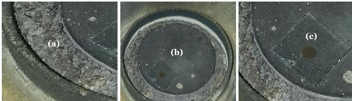
**Fig. 4 -12 a)** B -Sn contenido en la mufla, sobre el cual descansa la PT -AlN, **b)** PT - AlN con sustrato, **c)** sustrato sobre PT - AlN.
