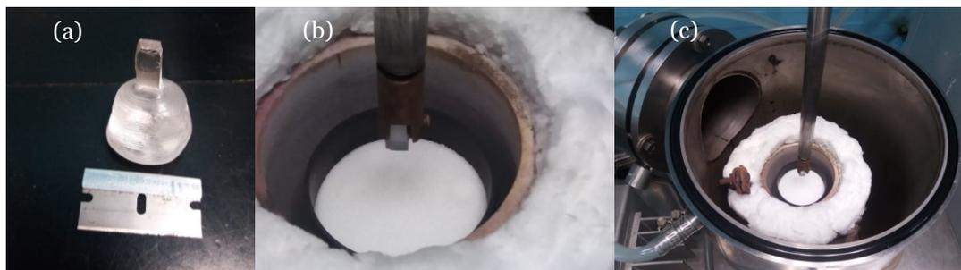
**Fig. 4 -2 a)** Monocristal de NaCl puro crecido mediante el método de Czochralski. **b) y c)** Varilla con la semilla de NaCl
