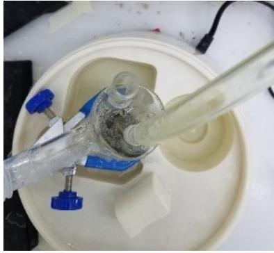
**Fig. 4 -13** Vista superior de las pinzas de soporte universal manteniendo fija la posición del CSP.
