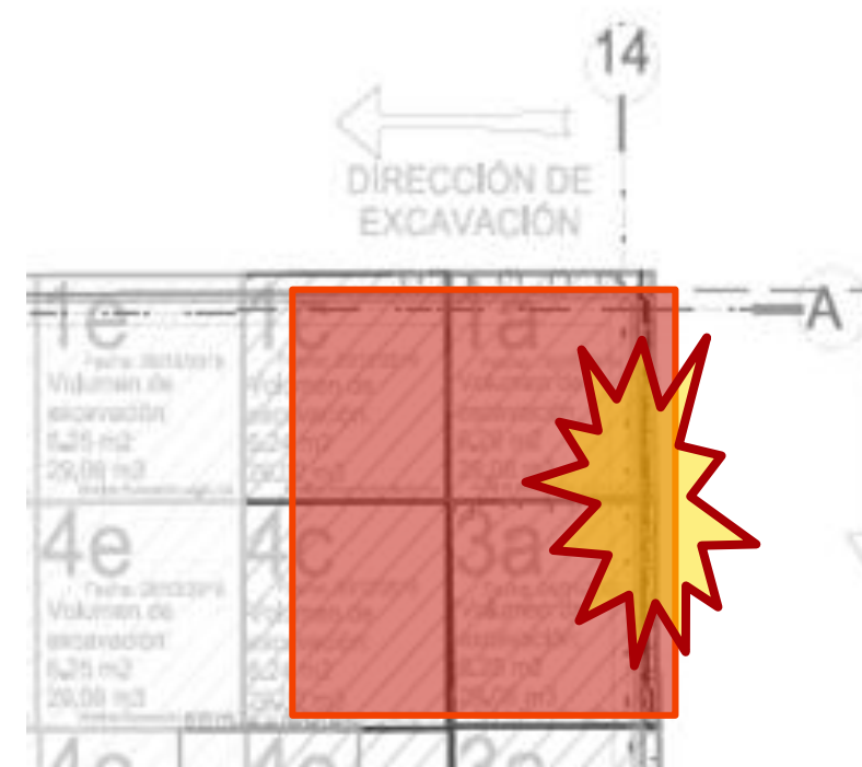
Imagen 28. Explicación grafica del derrumbe.
