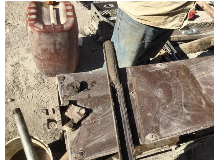
Imagen 10. Unificación de pruebas Identificación en campo de las muestras alteradas obtenidas con el penetrómetro estándar.
