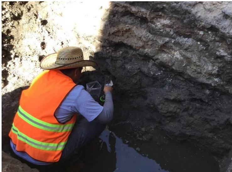
Imagen 09. Adquisición de estratos Obtención de muestras alteradas.
