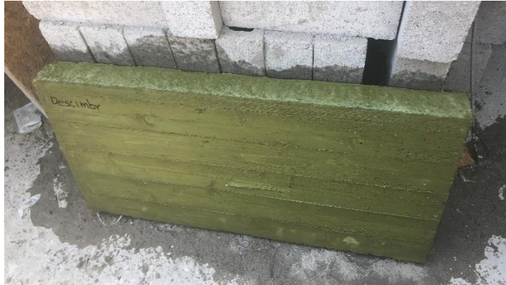
Imagen 47. Muestra con el concreto de los muros aparentes que irán al sótano y semisótano.
