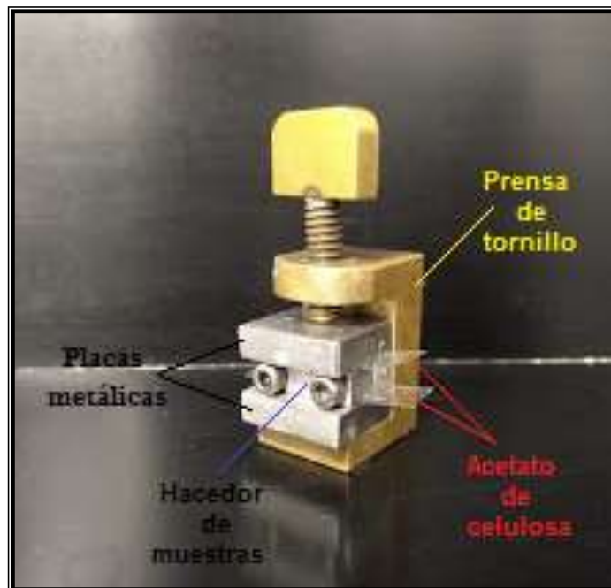
Figura 54: Se colocó en la prensa de tornillo una placa metálica en la base, el molde, o la placa metálica sobre el molde (la cinta Myler (acetato de celulosa) se colocó entre las placas metálicas y el molde para que no se adhiriera el material) y se ejerció presión.
