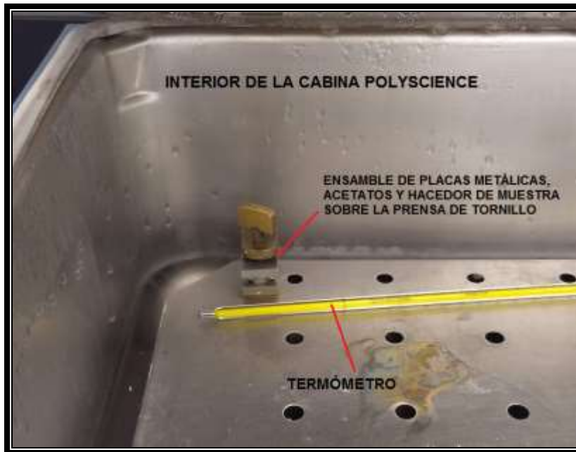
Figura 55: A) PolyScience: Cabina mantenida a 37\pm 1 °C y una humedad relativa de al menos 90%. B) En esta imagen se muestra el interior de la cabina con una de las muestras, se observa el agua que mantiene la humedad relativa y el termómetro se utiliza para controlar la temperatura interna.
