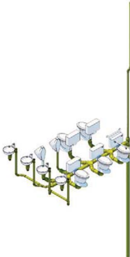
Imagen 80. Diagrama de instalación sanitaria , núcleo de baños, [elaboración propia].
