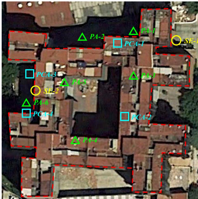
Figura 11. Ubicación de los trabajos de exploración
