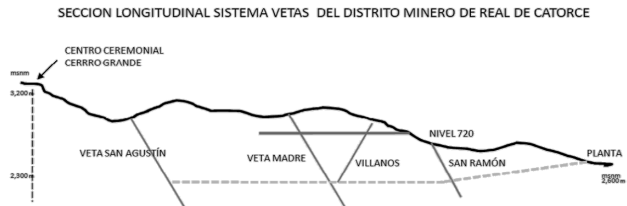
Figura 1. Esquema del sistema de vetas en Real de Catorce (recuperado de Gavilán, 2018, p. 81). Se representa el sistema de vetas en el distrito minero de Real de Catorce. En éste, el túnel se encuentra en el nivel 2,300 y es representado por la línea punteada en horizontal, que une las vetas con la planta ubicada a 2,600 msnm. Por otra parte, el “Nivel 720” señala la ubicación de los trabajos y remanentes de las minas que fueron utilizadas desde la época colonial. Además, se observa que, cerca de la Veta San Agustín y a una altura de 3,200 msnm, se encuentra el Centro Ceremonial “Cerro Quemado”, lugar sagrado para el pueblo wixárika.
