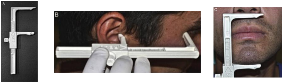
Imagen 8 A. Craneometro de Knebelman por su lado SET, con sus brazos, el superior fijo y el inferior móvil, con su tornillo de fijación. B Procedimiento de medición con el craneometro de Knebelman por su lado READ. C. Procedimiento de medición con el craneometro de Knebelman por su lado SET. 9
