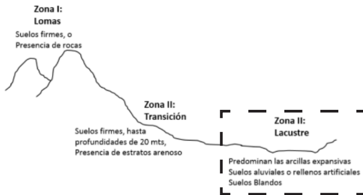
Imagen 24. Zonas según el tipo de suelo. (Imagen tomada del reglamento de construcción de la Ciudad de México.)
