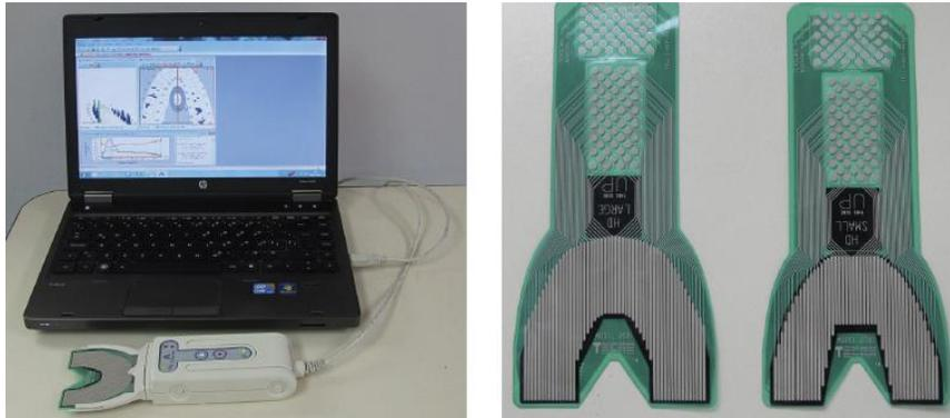
Figura 17. Sistema T-Scan® III instalado en laptop (lado izquierdo) y láminas transductoras (lado derecho).<sup>32</sup>
