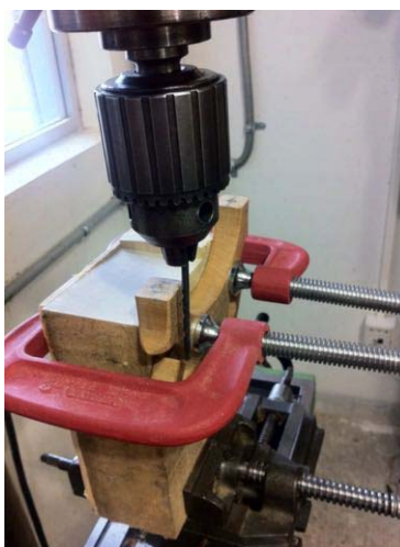
Fig. 27. Proceso de colocación de elevadores de altura en el puente
