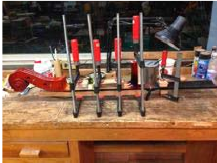
Fig. 37. Encolado de brazo y diapasón.
