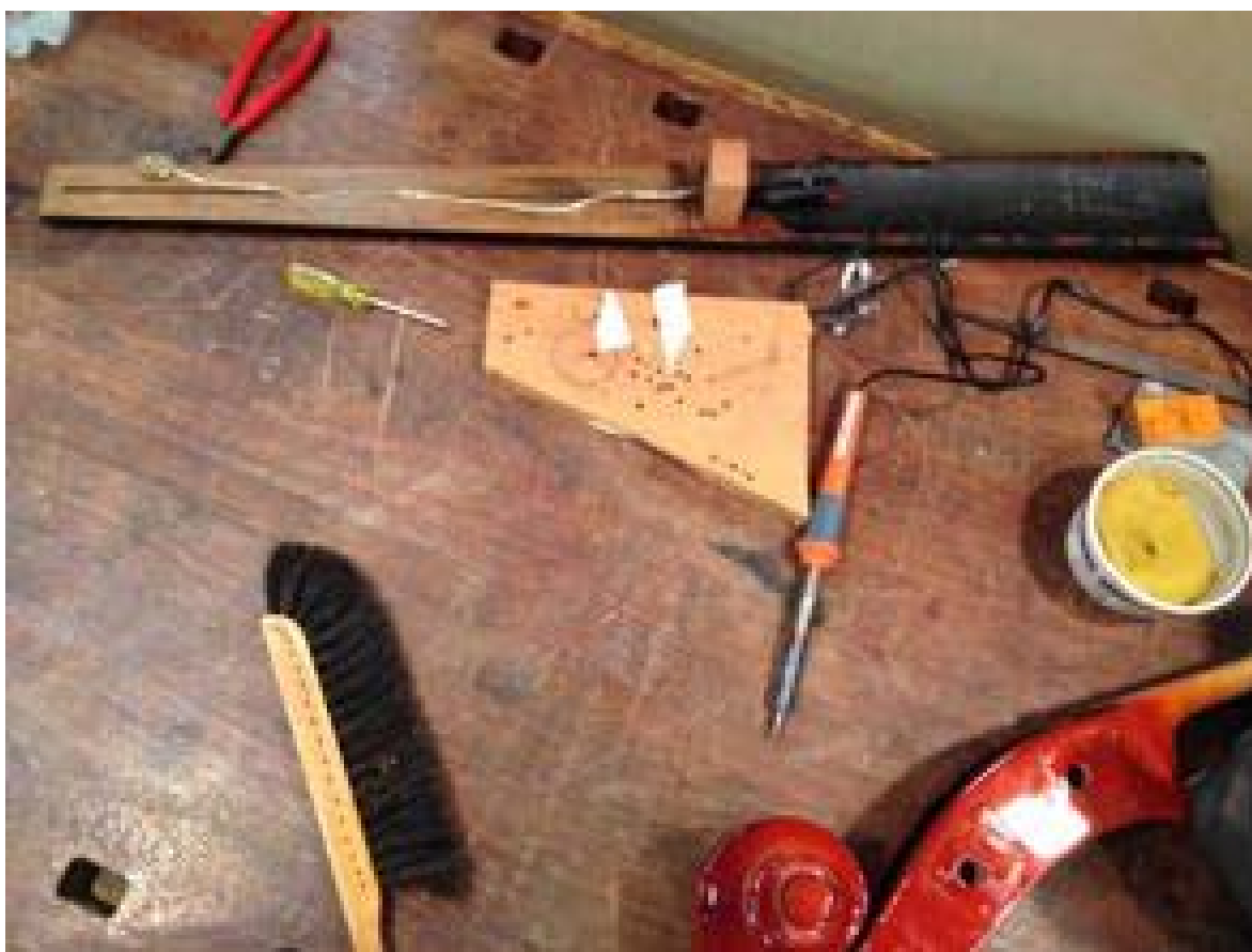
Fig. 36. Piezoeléctrico definitivo y su posición aproximada dentro de la tastiera.
