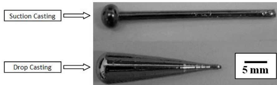
Figura 2.5.- Piezas obtenidas por colada por succión y por drop casting .
