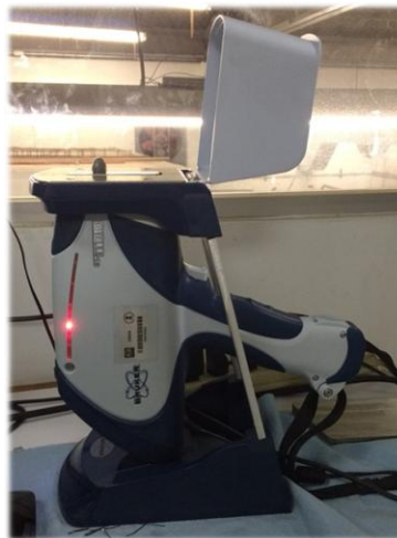
Figura 3.9.- Imagen del equipo Bruker-Titan S1 empleado para el análisis químico.
