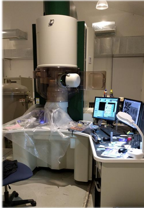
Figura 2.16.- Microscopio electrónico de transmisión, marca JEOL modelo JEM-ARM200F
