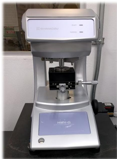
Figura 2.17.- Microdureza, marca Shimadzu modelo HMV-G.
