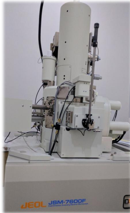
Figura 2.14.- Microscopio electrónico de emisión de campo, marca JEOL JSM-7600F
