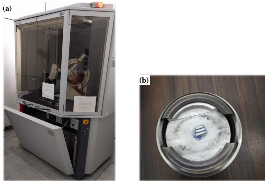
Figura 3.10.- Imágenes (a) Equipo de difracción de Rayos X marca Bruker modelo d8 Advance (b) Porta-muestras empleado en el equipo.
