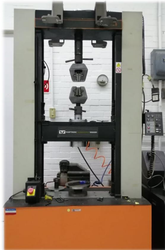
Figura 2.18.- Equipo universal para ensayo de compresión, marca Instron modelo 11225.
