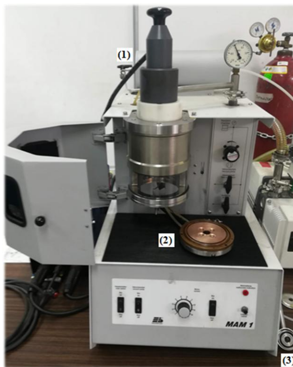
Figura 2.4.- Horno de arco eléctrico con los accesorios para llevar a cabo suction casting
