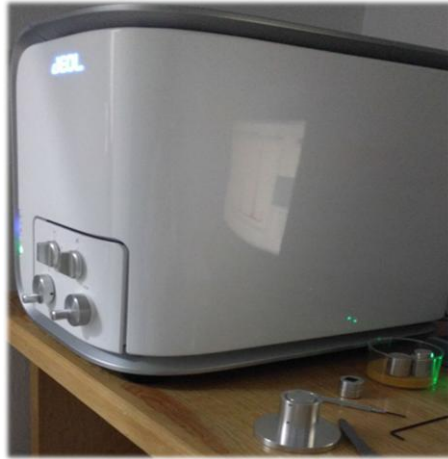
Figura 2.13.- Microscopio electrónico de barrido, marca JEOL modelo NeoScope JCM-6000
