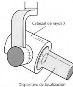
Figura 6. Dispositivo indicador de posición (DIP) o cono. <sup>(11)</sup>
