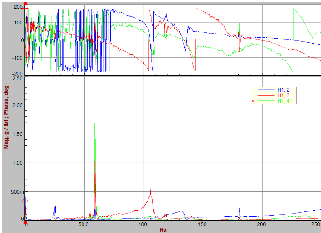
Ilustración 33. Modos identificados a 0 psi en prueba de impulso.
