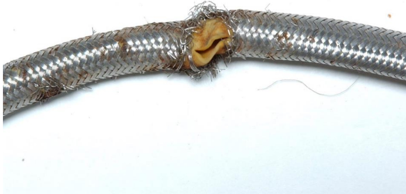
Ilustración 7. Falla en Manguera Metálica por radio de doblez limitado [7].
