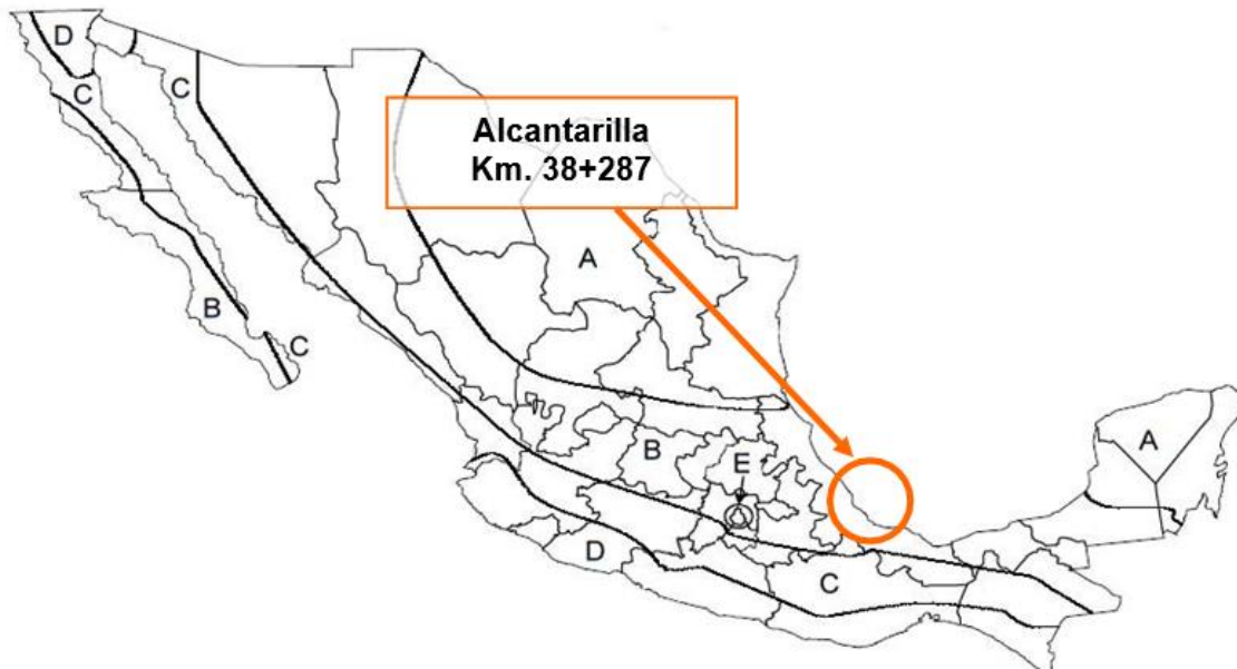
Figura 3.2.(g) Regionalización sísmica de la Republica Mexicana de acuerdo a la Norma SCT-N-PRY-CAR-6-01-005-01 (SCT,2001).
