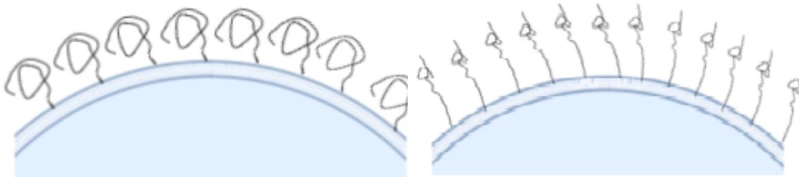
**Figura 7.** Representación de las conformaciones estructurales del PEG en la superficie liposomal. A la izquierda la conformación en forma de hongo, a la derecha la conformación en forma de cepillo.
