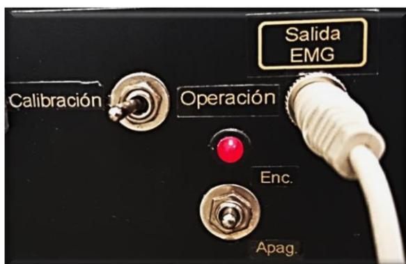
**Imagen 43.** El interruptor se coloca en calibración para comenzar a calibrar.
