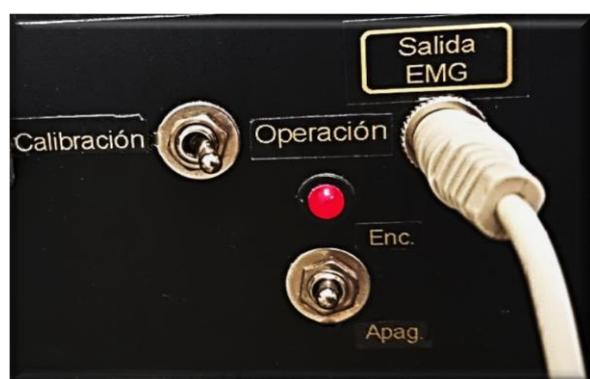
**Imagen 44.** El interruptor se coloca en dirección operación para finalizar la calibración.
