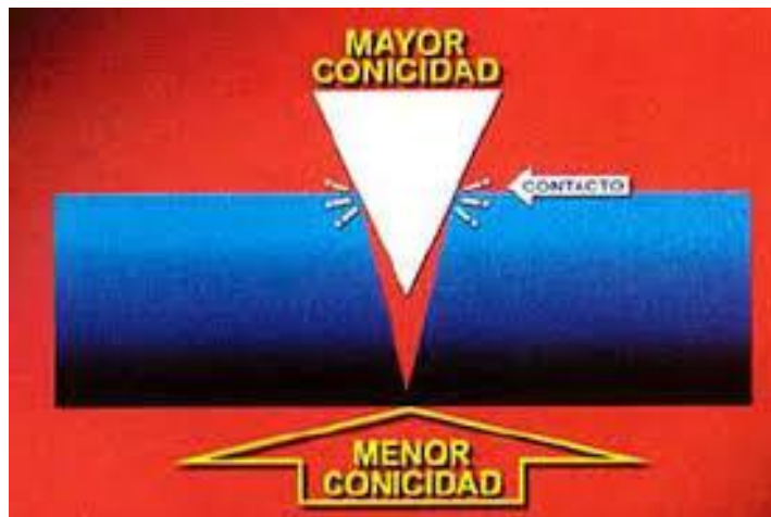
Fig.11. Conicidad de los instrumentos de NiTi. Cuanto menor es el área de contacto menor será la presión ejercida (13).
