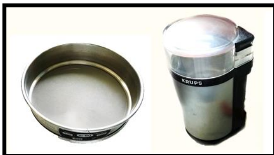
Figura 3. Molino y malla que proporcionaron un tamaño de partícula <250 µm.
