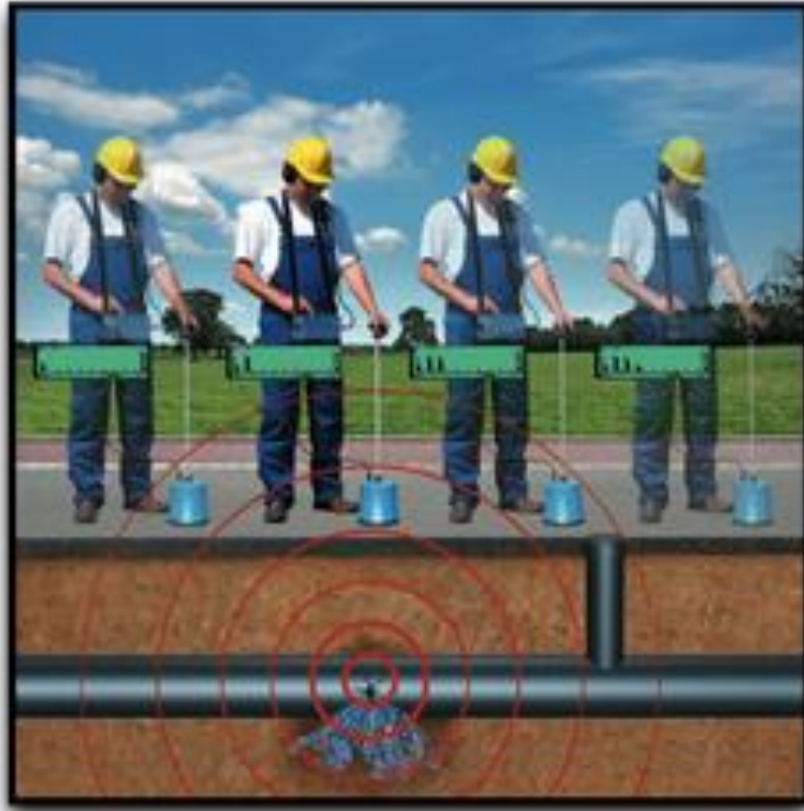
Figura 15. Geófono, microfóto de piso.
