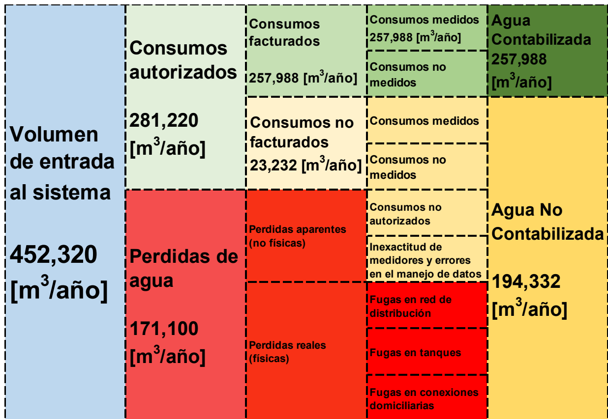
Figura 30. Balance hidráulico del Sector BJ-02.
