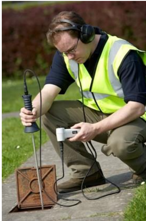
Figura 16. Geófono, varilla acústica/micrófonod e mano.
