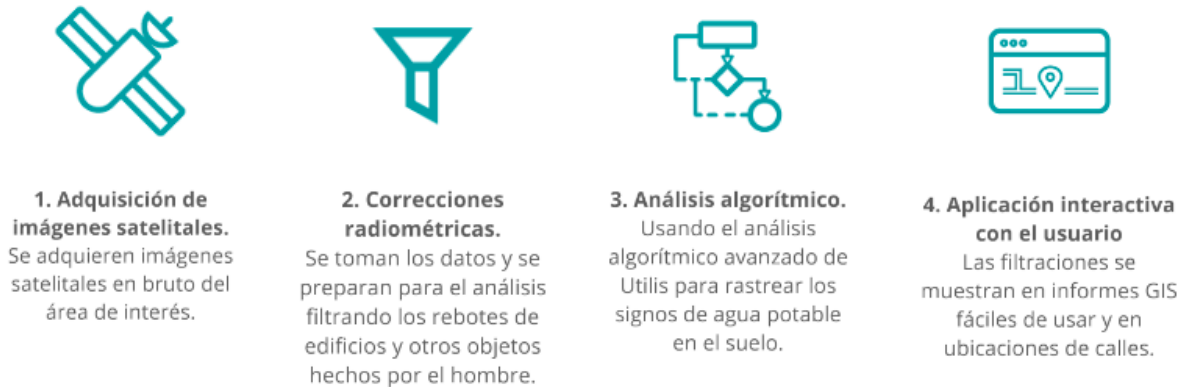
Figura 22. Detección de Fugas mediante Imágenes Satelitales, Operación.
