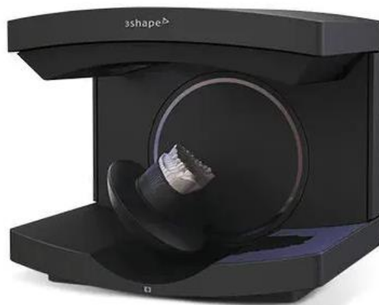
Figura 34 Ejemplo de un lab-scanner con el que se puede obtener un modelo digital en 3D. 8
