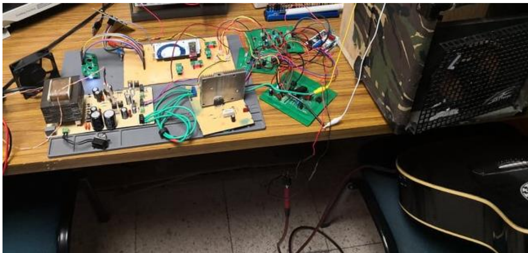
Ilustración 4.42 Pruebas con la fuente con todo el sistema conectado con audio de un guitarra electroacústica.
