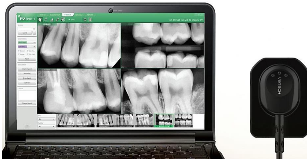
Figura 45. Radiovisiógrafo digital directo. Tomada de: EDR Digital. https://bit.ly/3djca9n
