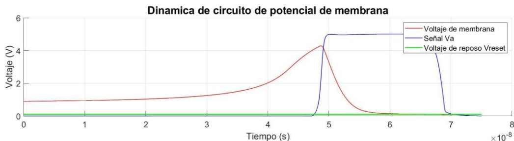
Fig.47 Dinámica de circuito de potencial de membrana.
