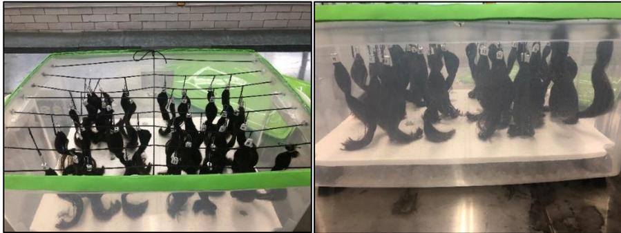
Figura 5. Colocación del mechón en la cámara climática.
