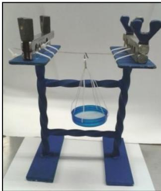
Figura 16. Montaje del equipo para evaluar resistencia.
