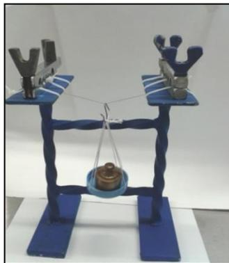
Figura 17. Equipo para evaluar resistencia con pesa de 200 g
