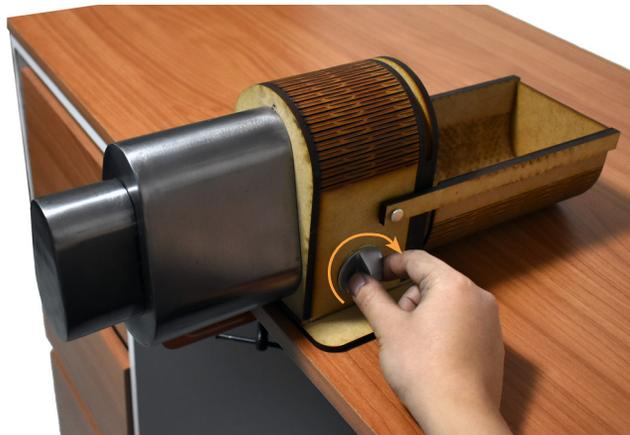
Regulación de la temperatura por medio de la perilla del termostato
