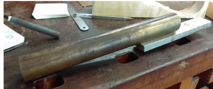
Imagen 16, Cera A. (2019) Dobladora-Pedro Cisneros, Dobladora de tubo de latón unida con tornillo y tuerca a una placa de aluminio, funciona con una resistencia de cañón.
