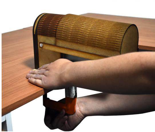
Instalación y sujeción de la dobladora en la mesa de trabajo
