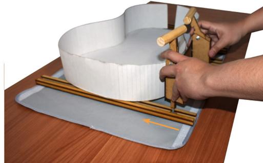
Deslizar la prensa en los canales de las guías
