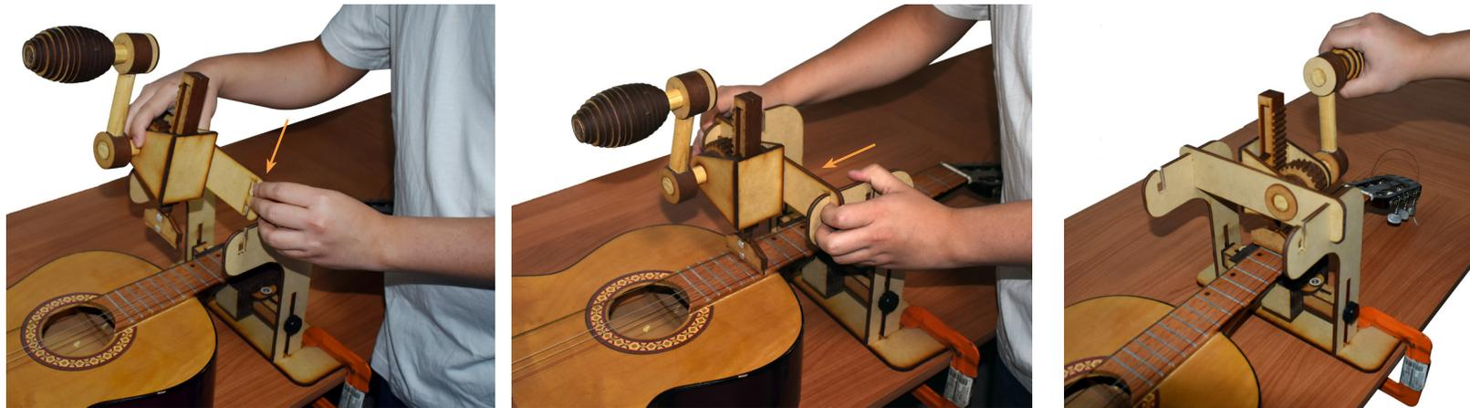
Ensamblaje de la prensa-cremallera de manera invertida en la segunda ranura para poder acceder a los últimos trastes
