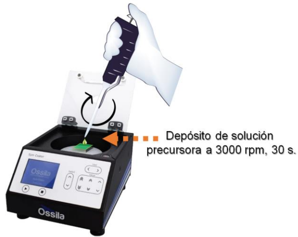
Figura 11. Depósito de solución precursora de ZnO vía spin-coating.
