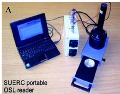
Figura 12. Materiales utilizados para realizar el análisis de OSL A. Equipo SUERC portable utilizado para mediciones. B. Ejemplo de recipientes utilizados para almacenar sedimentos y realizar mediciones en el equipo.
