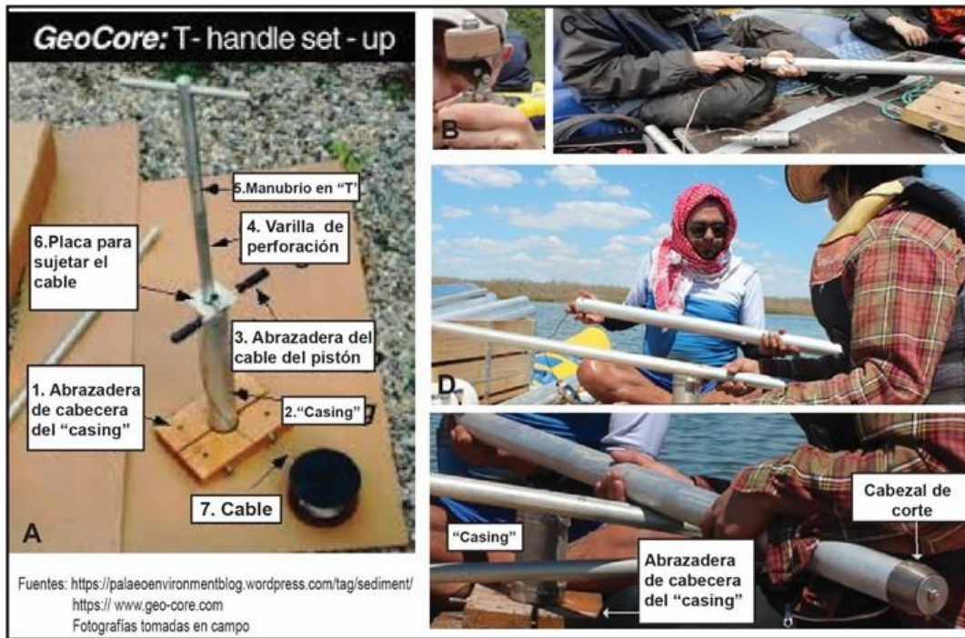
Figura 6. Equipo de perforación. A. Partes del equipo para perforación. B. Pistón tipo Livingstone modificado. C. Ejemplo de cómo se ingresa el pistón en el tubo de aluminio donde se almacena sedimento. D. Fotografías en campo de preparación del pistón dentro del tubo de aluminio. E. Fotografía del pistón ingresado con el cabezal de corte, listo para ingresar a través del "casing".
