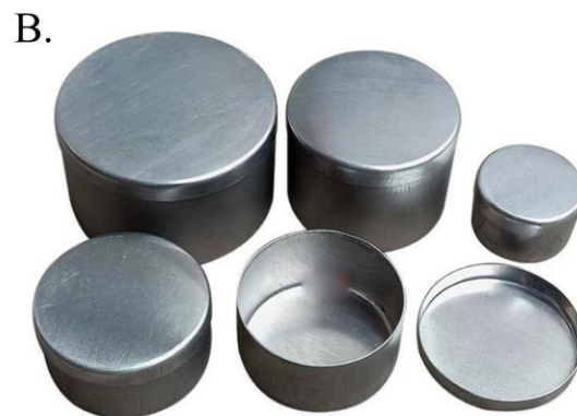
Figura 12. Materiales utilizados para realizar el análisis de OSL A. Equipo SUERC portable utilizado para mediciones. B. Ejemplo de recipientes utilizados para almacenar sedimentos y realizar mediciones en el equipo.
