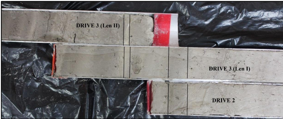
Figura 7. Ejemplo de empalme para elaborar sección compuesta en núcleos de la laguna La Encantada.
