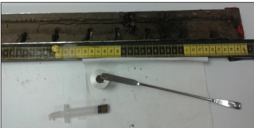
Figura 8. Herramientas utilizadas para realizar el muestreo de los núcleos en el laboratorio.
