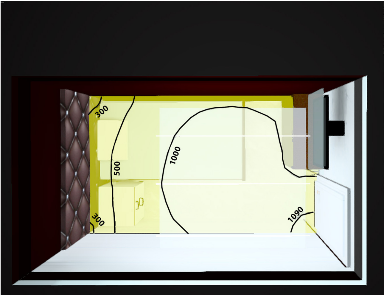
Imagen 45. Nivel de luz. Promedio 1,000 lx con 0% de atenuación. Render por Pamela Morales.
