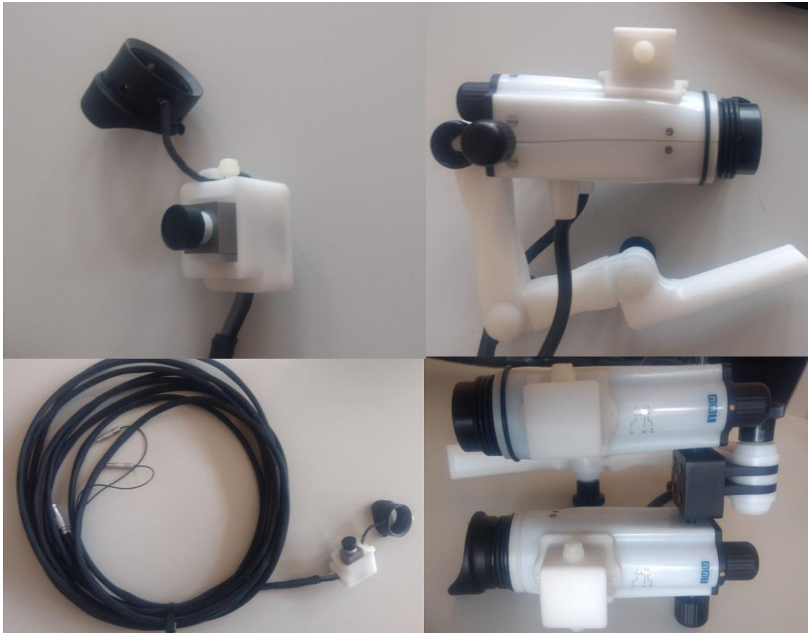
Figura 10. Sistema de rastreo ocular adaptado para resonancia magnética empleado en este protocolo.
