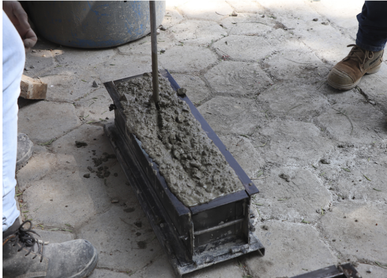
Figura 3.11: Colocación de la última capa de concreto.
