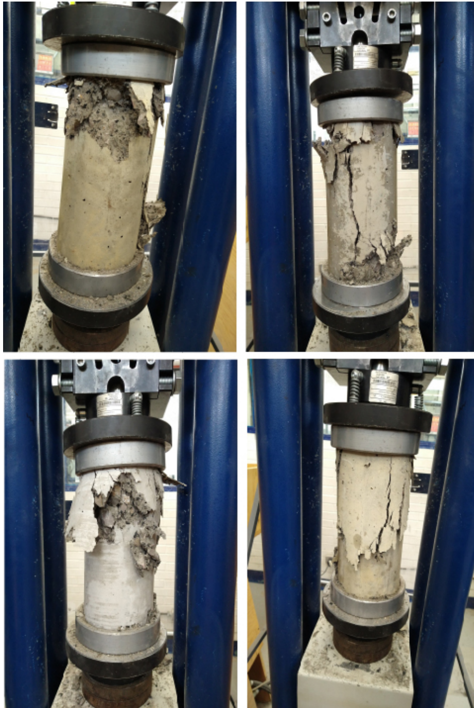
Figura 4.6: Fracturas visibles en los especímenes de CCF.
