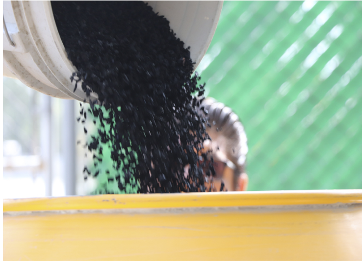
Figura 3.7: Incorporación del caucho a la mezcla de concreto.
