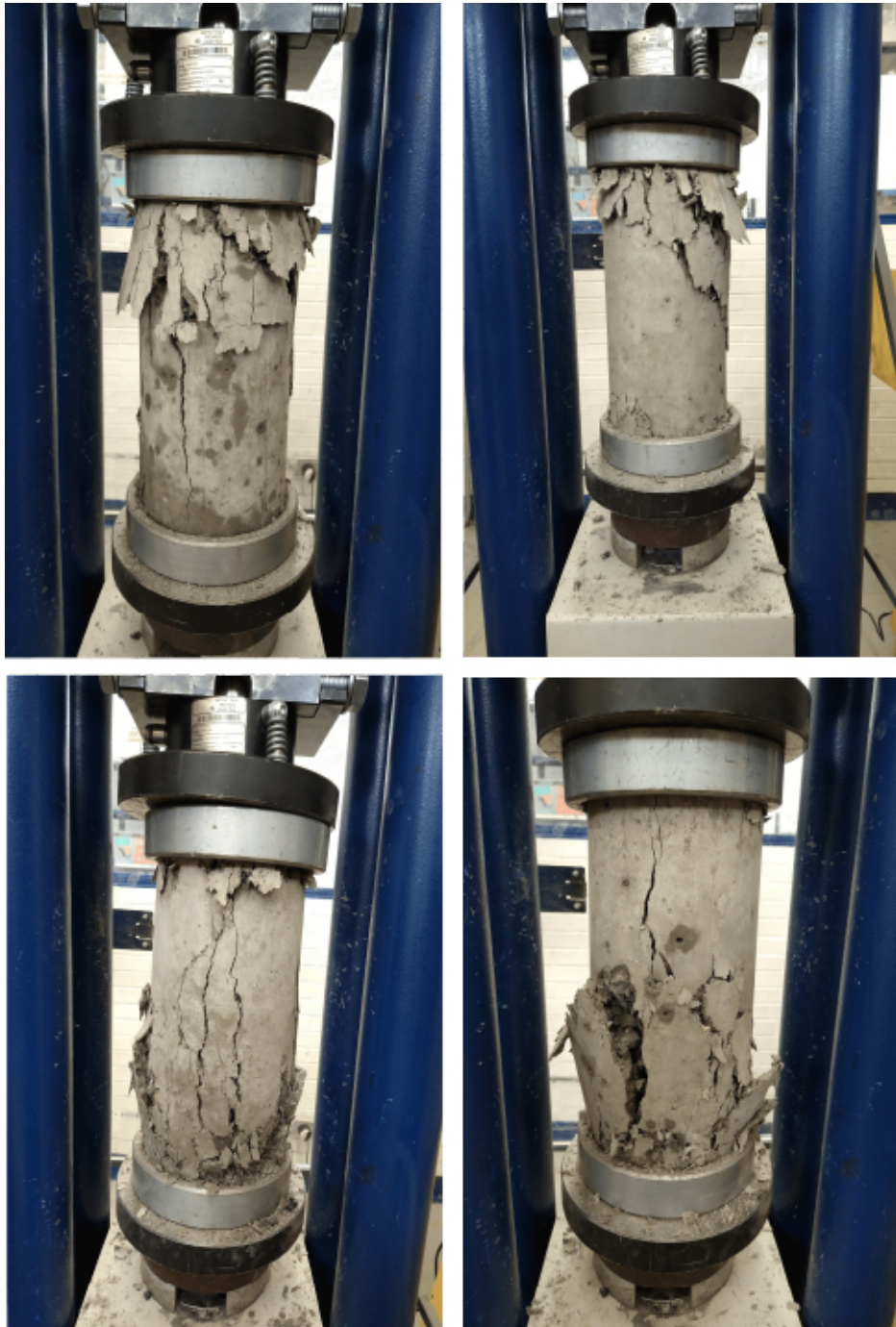
Figura 4.7: Fracturas visibles en los especímenes de CCG.
