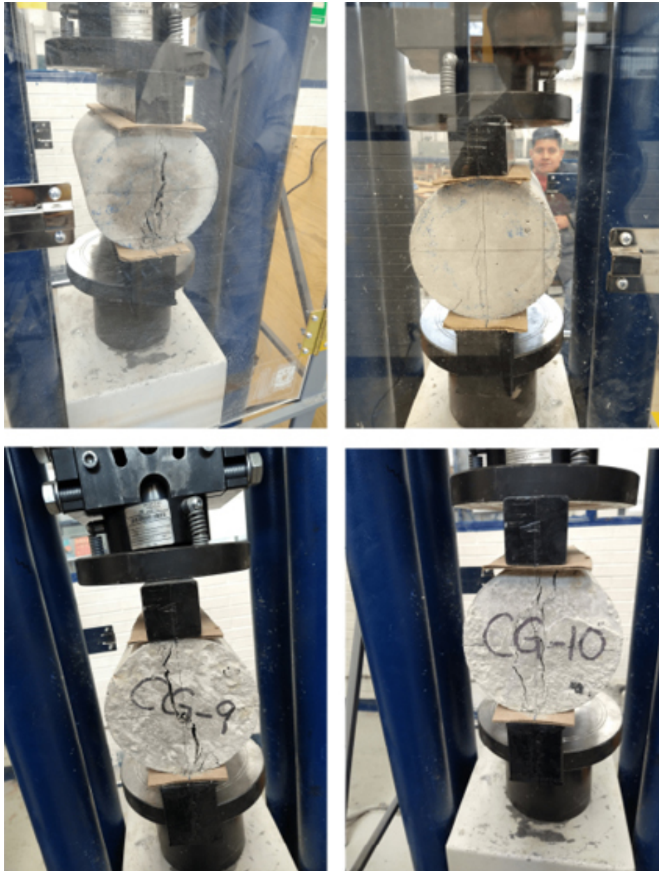
Figura 4.19: Fracturas visibles después de la prueba de resistencia a la tensión en los especímenes de CCG.
