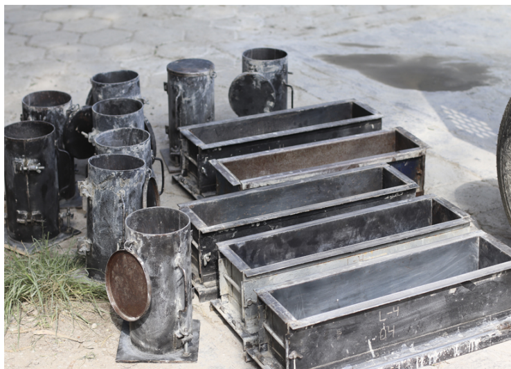
Figura 3.3: Preparación de moldes.
