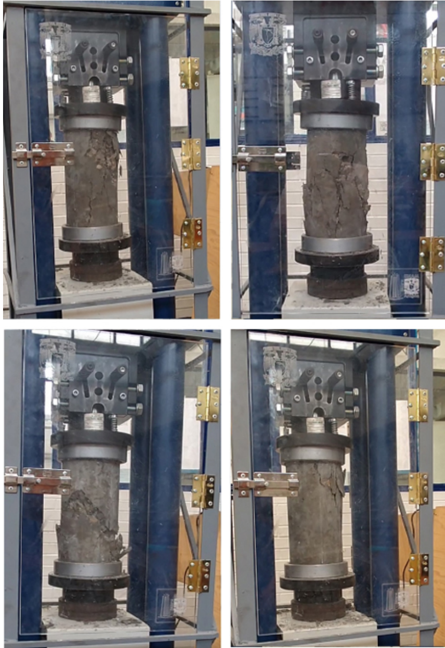
Figura 4.5: Fracturas visibles en los especímenes de CS.
