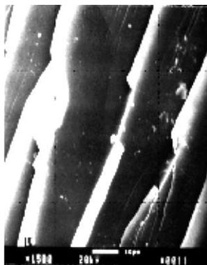
**Figura 23.** Morfología de la fractura del análisis de impacto del nanocompuesto.
