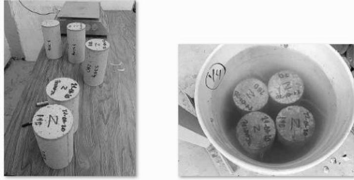
Imagen 77. “Desenfrado y pesado de cilindros”
