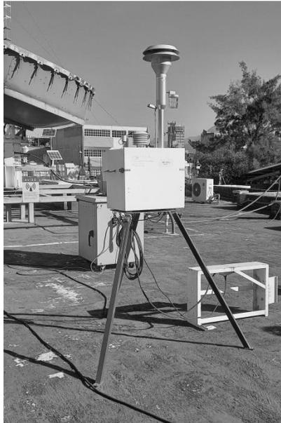
Imagen 94. "Equipo muestreador de partículas BGI PQ200"
