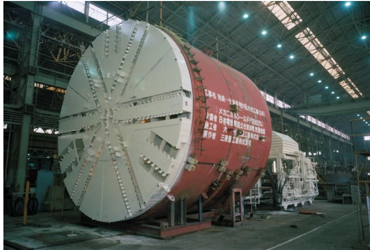
Figura 7.- Hidroescudo, adaptado de presentaciones Ing. Roberto González Izquierdo, AMITOS Moldequipo Internacional, S.A. de C.V., notas de clase.
