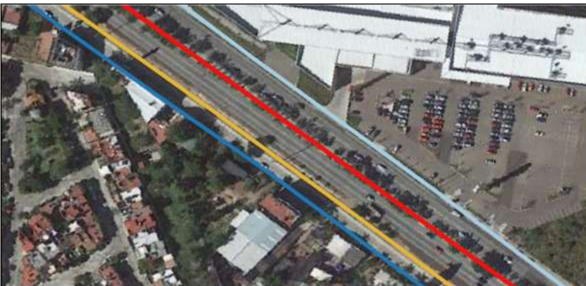
Figura 33. Representación del tipo 4 dónde se considera: banqueta derecha (azul claro), camellón central (rojo), camellón lateral izquierdo (amarillo) y banqueta izquierda (azul fuerte).
