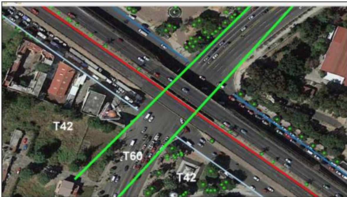
Figura 18. Ejemplos de tipologías en doble piso. Tipo de tipología (línea verde), banqueta derecha (línea azul claro), camellón central (línea roja) y baqueta izquierda (línea azul fuerte).
