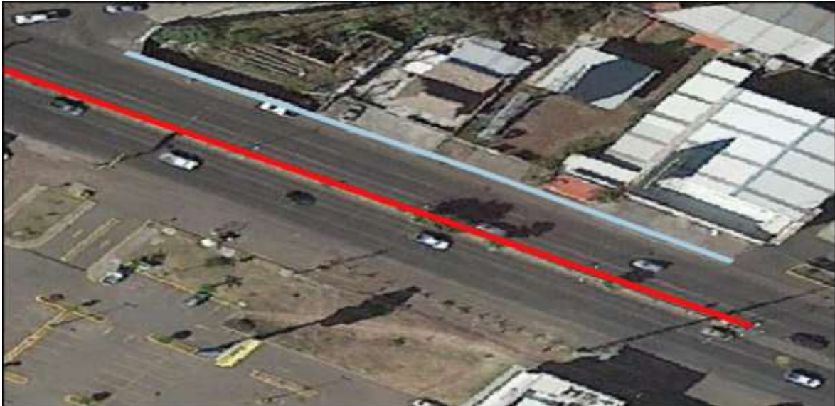
Figura 32. Representación del tipo 22 dónde se considera: banqueta derecha (azul claro) y camellón central (rojo).
