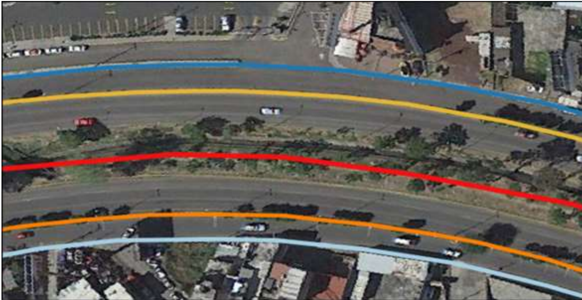
Figura 34. Representación del tipo 1 dónde se considera: banqueta derecha (azul claro), camellón lateral derecho (naranja), camellón central (rojo), camellón lateral izquierdo (amarillo) y banqueta izquierda (azul fuerte).
