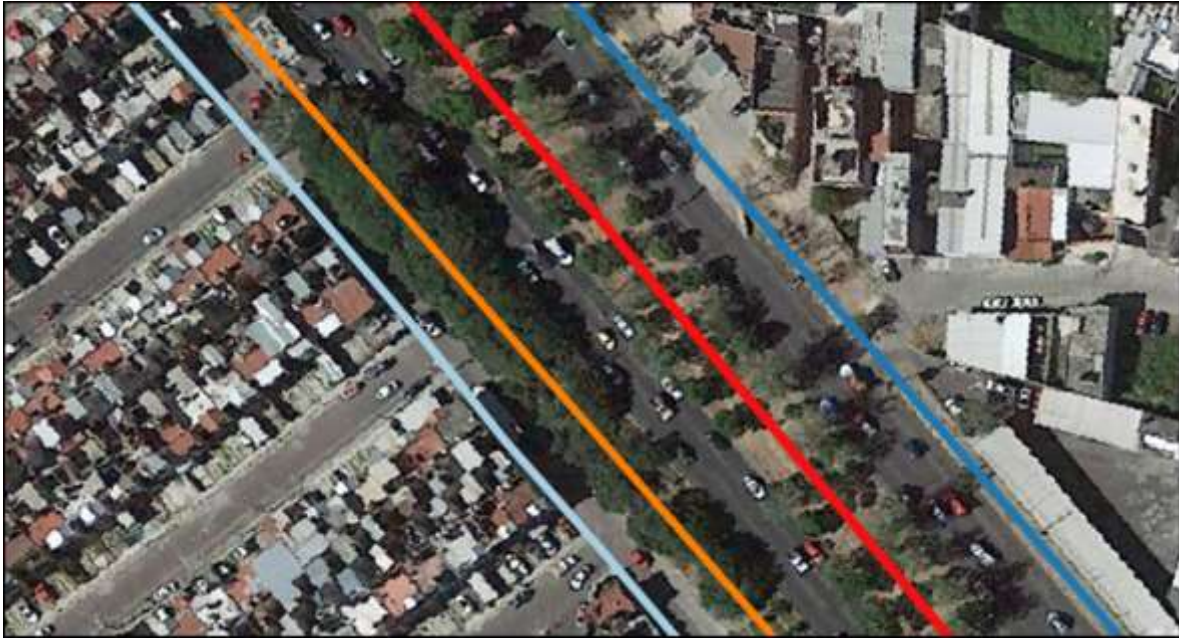
Figura 35. Representación del tipo 2 dónde se considera: banqueta derecha (azul claro), camellón lateral derecho (naranja), camellón central (rojo) y banqueta izquierda (azul fuerte).
