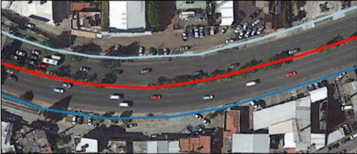
Figura 30. Representación del tipo 11 dónde se considera: banqueta derecha (azul claro), camellón central (rojo) y banqueta izquierda (azul fuerte).
