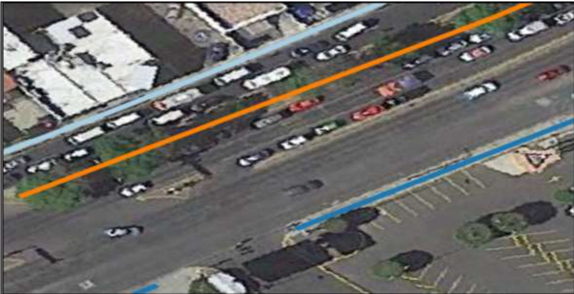
Figura 37. Representación del tipo 12 dónde se considera: banqueta derecha (azul claro), camellón lateral derecho (naranja) y banqueta izquierda (azul fuerte).
