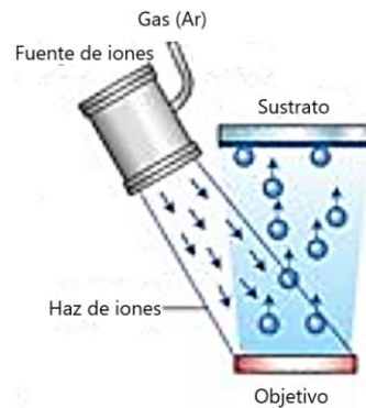
Figura 2.10 Mecanismos de depósito por pulverización por haz de iones [29].
