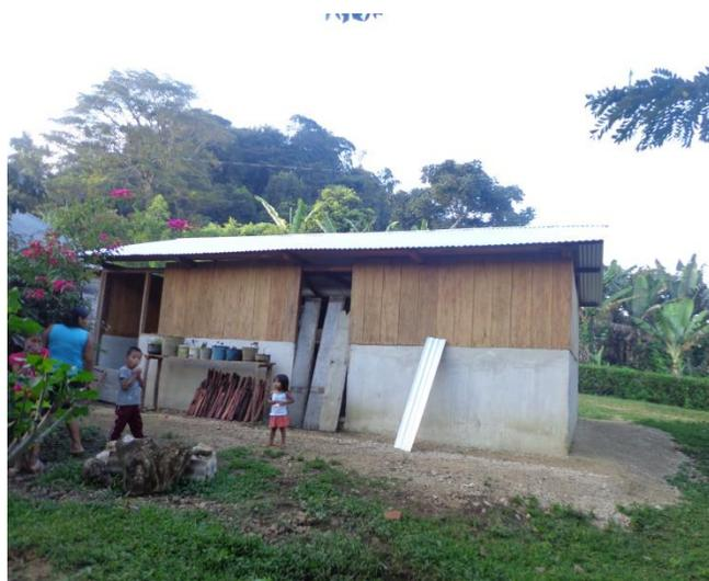
Figura 49. Vivienda elaborada con pared de concreto y tablas de *c'anxan*.
