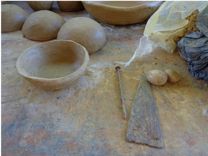
Figura 68. Detalle de herramientas: clavo, punta de machete y pulidores de río.
