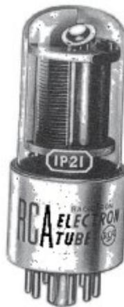
Figura 13. Diagrama y fotografía del fotomultiplicador RCA 1P21. (Miles 2007, 180)
