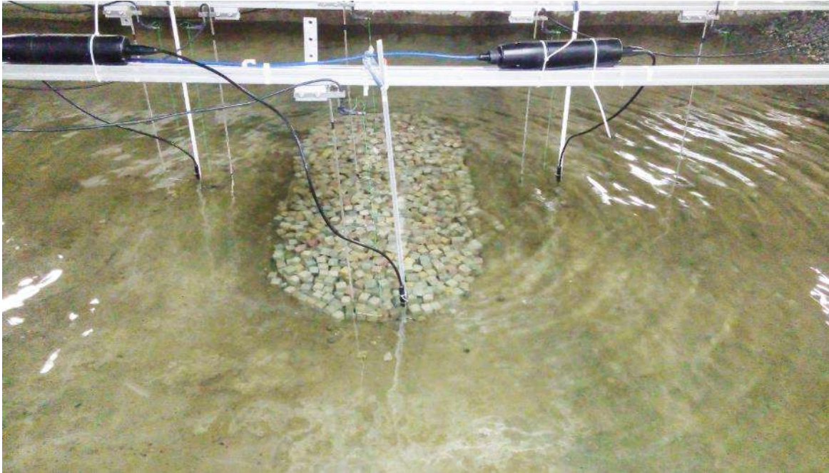
Figura 43. Reflexión provocada por el dique sumergido construido con cubos, se muestra del lado derecho la difracción producida por el obstáculo.
