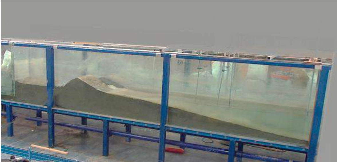
Figura 75. Perfil A, construido con arena, sometido a oleaje irregular con espectro Jonswap H=0.05m , T=1.118s , h=0.45m .
