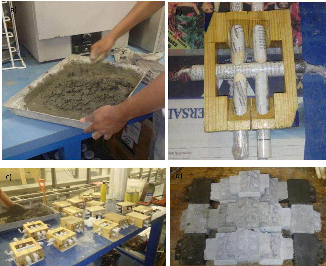
Figura 24. Proceso de colado a) mezcla, b) cimbra, c) cimbra completa, d) piezas coladas.
