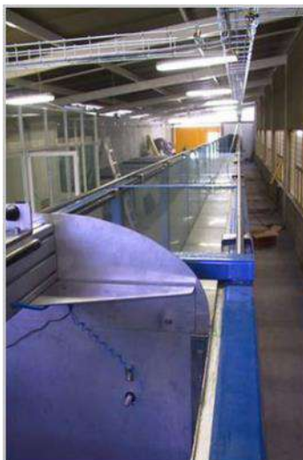
Figura 31. Canal de Oleaje, permite reproducir oleaje regular e irregular mediante el software HR Wallingford (fuente: Instituto de Ingeniería UNAM).
