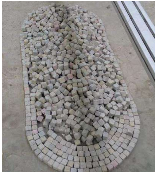
Figura 27 Rompeolas sumergido construido con cubos de concreto.
