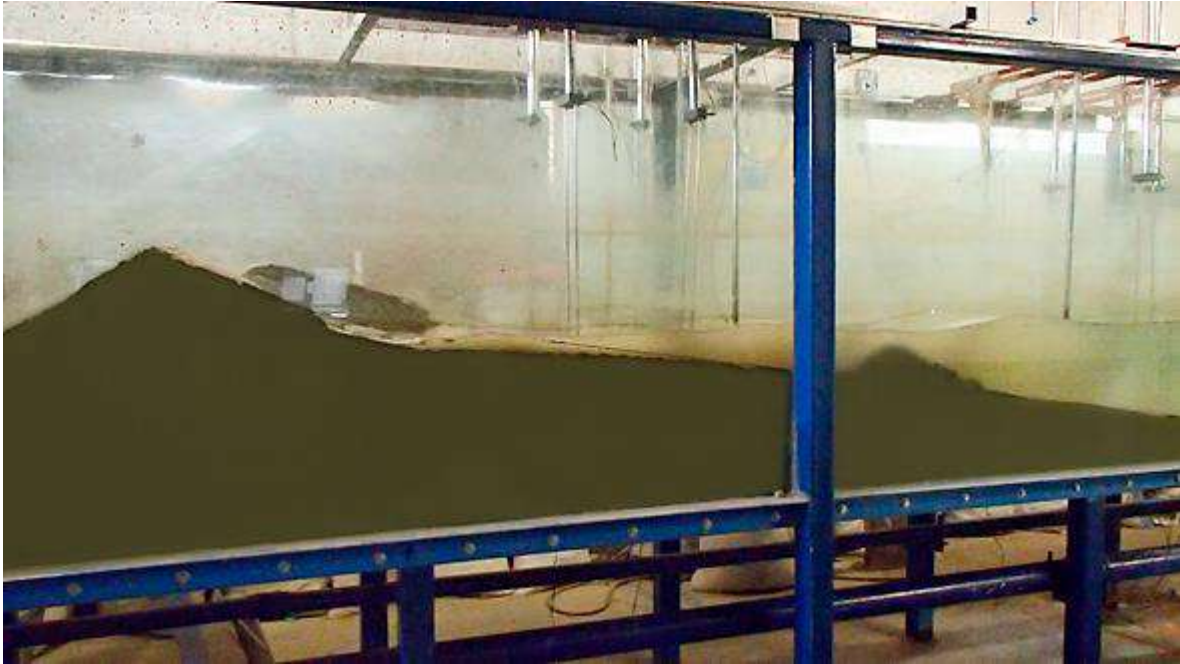
Figura 78. Perfil A, construido con arena, sometido a oleaje irregular con espectro Jonswap H= 0.10m , T=1.118s , h=0.48m
