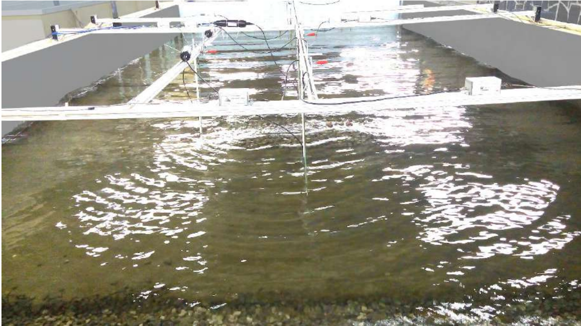
Figura 44. Transmisión y difracción del oleaje, producido por el dique sumergido construido con cubos.
