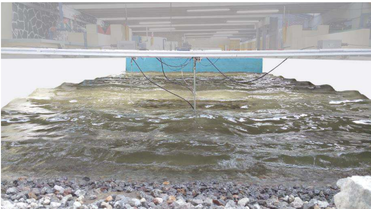
Figura 46. Oleaje transmitido y difractado por el dique modular sumergido.
