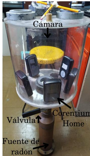
**Fig. 3.12:** Equipos Corentium Home dentro de una cámara de radón.
