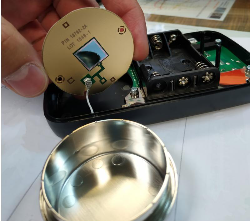
**Fig. 3.8:** Fotodiodo PiN dentro del Corentium Home.
