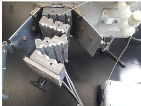
Figura 2. Equipo para acondicionar los cartuchos con gas inerte a una temperatura de 300 °C.
