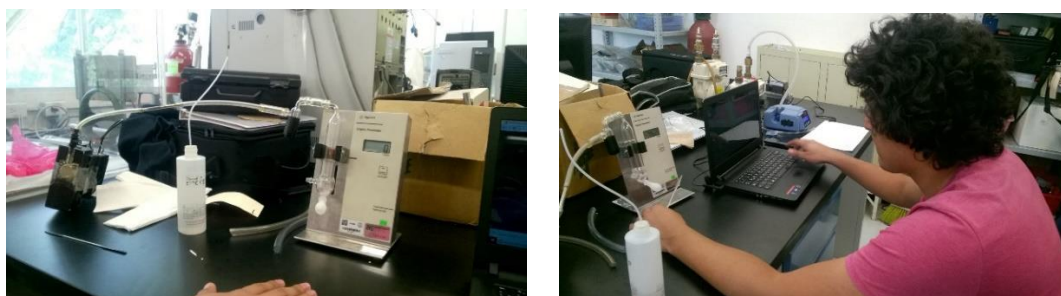
Figura 4. Bomba SKC conectada al equipo de calibración en el panel izquierdo y la calibración del equipo en el panel derecho.
